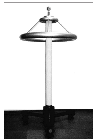
図2 インパルス電圧測定システムに用いる分圧器の外観
