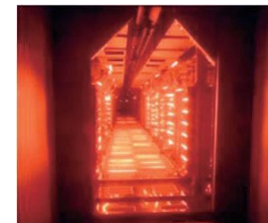
改善後の実物写真 乾燥炉内（ヒータ全照射時）
