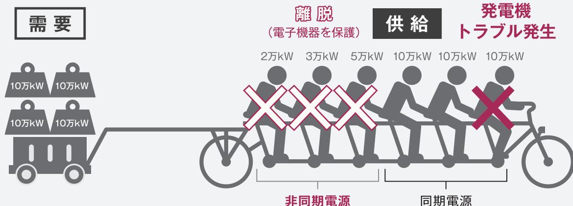
同期電源は周波数低下を立て直す力を持つが、非同期電源は周波数の変動が一定の幅を超えた場合、連鎖的に離脱して需要と供給のバランスが崩れ、停電が発生する懸念がある
