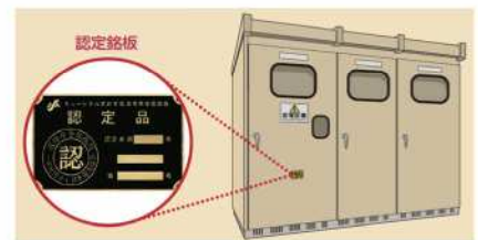
キュービクル式非常電源専用受電設備
